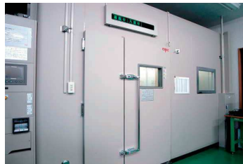
恒温恒湿設備
